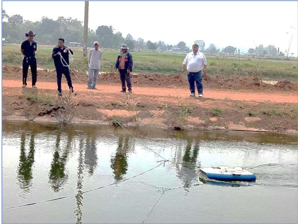
รูปที่ ค3 การวัดน้ำด้วยเครื่องวัดกระแสน้ำด้วยคลื่นเสียง คลอง RMC กม.13+000 วันที่ 22 กุมภาพันธ์ 2560
